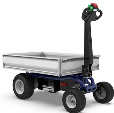
PLATAFORMA 720 x 1325 x h185 mm 890 x 1325 x h185 mm
