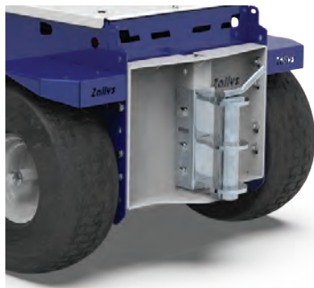
Gancho con perno Ø16 / 20 / 35 / 40 mm
